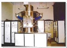
進科研發有限公司製造的生物材料研究和工藝專用的 等離子體浸沒式離子注入機
